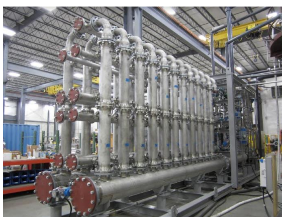
Système d'équipement de filtration CeraMem. Débit d'écoulement de 600gpm (135m 3 /heure)
